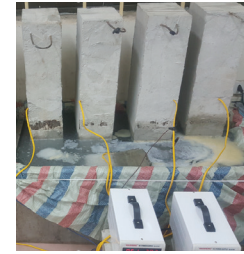
Hình 4. Quá trình gia tốc ăn mòn cốt thép cho 4 dầm L1R1, L1R2, L2R1 và L2R2.
