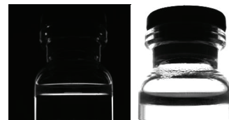
Hình 7. Ảnh chụp lọ vắc-xin bằng phương pháp trường tối và từ phía sau.
