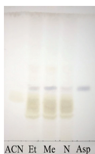
Hình 2. SKLM khảo sát thành phần các dịch chiết thuốc bột BT. ACN: dịch chiết acetonitril; Et: dịch chiết ethanol 96%; Me: dịch chiết methanol; N: dịch chiết nước; Asp: dung dịch acid asperulosidic đối chiếu.
