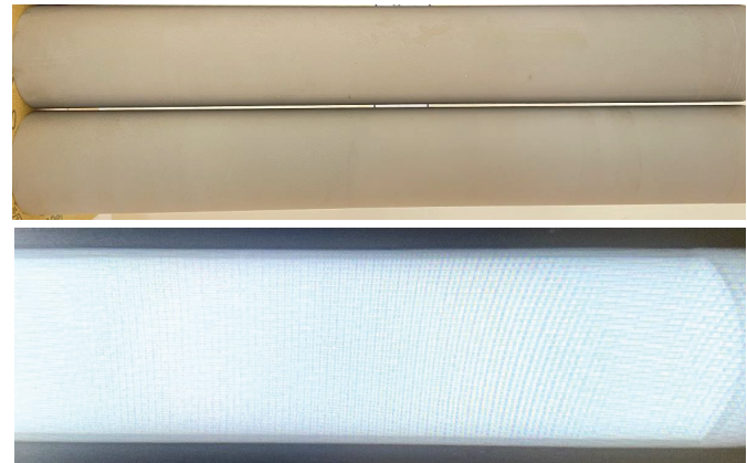
Hình 5. Kết quả chụp X-quang thổi nhiên liệu sau khi phủ chống cháy.
