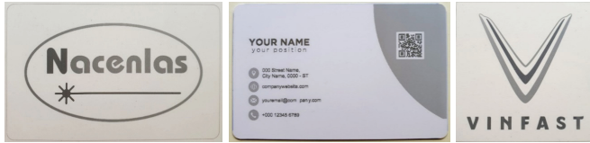
Hình 9. Một số mẫu thử nghiệm khắc laser UV bước sóng 355 nm trên các vật liệu nhựa PVC, ABS, PP.
