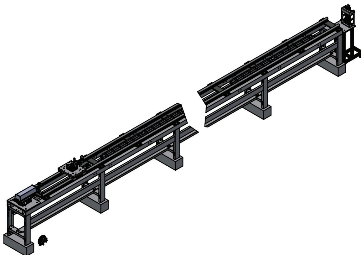
Hình 16. Hệ thống thiết bị hiệu chuẩn/kiểm định thước cuộn, thước vạch.
