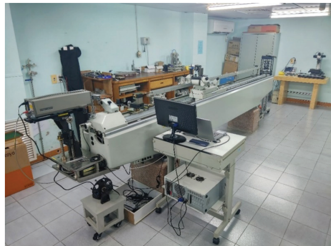
Hình 1. Máy đo độ dài 3 m sử dụng giao thoa kế laser.
