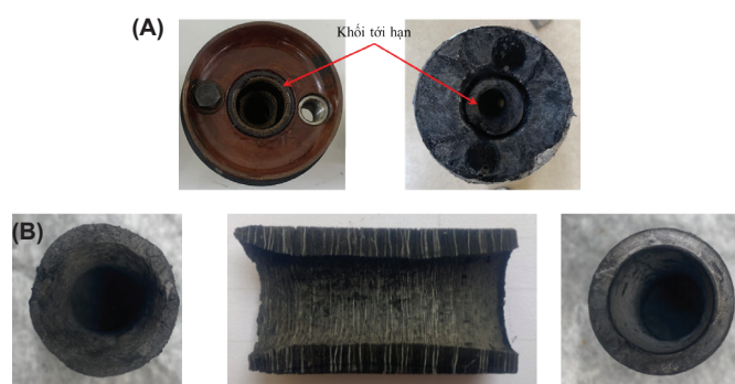
Hình 5. Cụm loa phụt. (A) Cụm loa phụt trước và sau khi đốt thử nghiệm; (B) Khối tới hạn sau khi đốt thử nghiệm.
