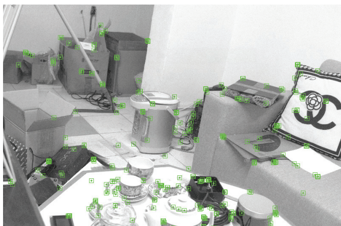
Hình 16. Các điểm tương đồng (màu xanh) được phát hiện giữa 2 khung hình liên tiếp sau khi tính toán các Keypoint bằng FAST và so khớp đặc trưng ORB.
