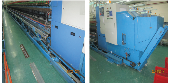
Hình 12: hệ thống đồ sợi tự động cho máy sợi con
