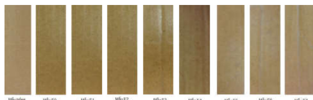
Hình 3: thử nghiệm độ trong của màng phủ sử dụng nhựa EMULTEX 8200 sau khô
