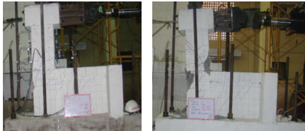
(a) mẫu C1 (b) mẫu C2 Hình 8: hình ảnh hình thành vết nứt của mẫu thí nghiệm
