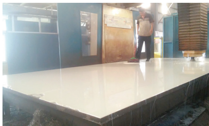
Hình 5: chi tiết bàn máy được phay phẳng bề mặt trên
