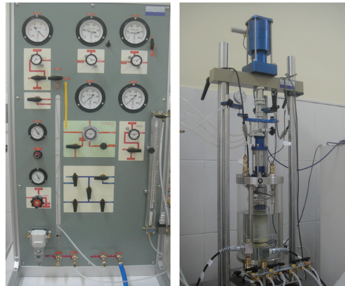
Hình 1: hệ thống thiết bị thí nghiệm 3 trục động DTC - 367D
