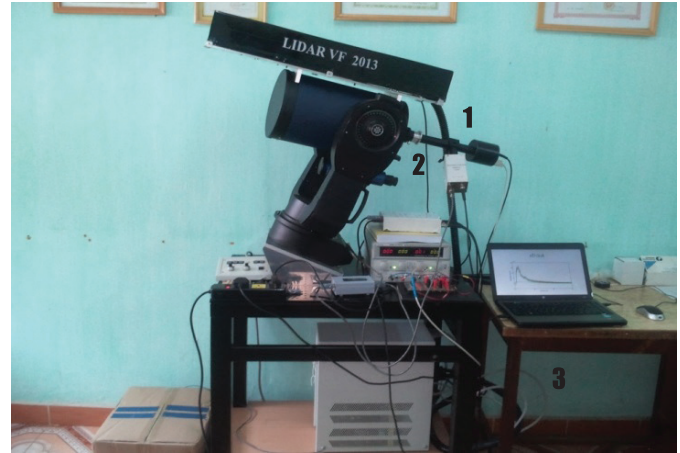
Hình 1: ảnh hệ LIDAR VF đo đồng thời hai kênh 532 nm và kênh 1064 nm (1. Khối phát; 2. Khối thu; 3. Khối xử lý số liệu)
