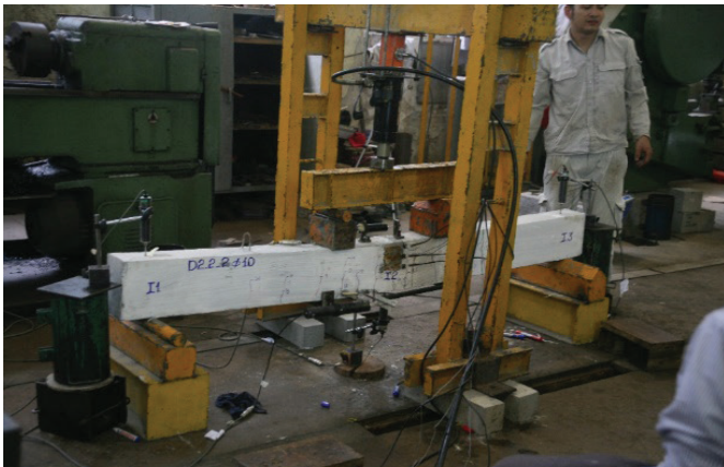
Hình 8. Dầm thí nghiệm ở trạng thái bị phá hoại uốn.
