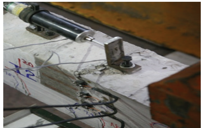
Hình 9. Đo biến dạng tương đối của bê tông vùng nén trên dầm thí nghiệm.
