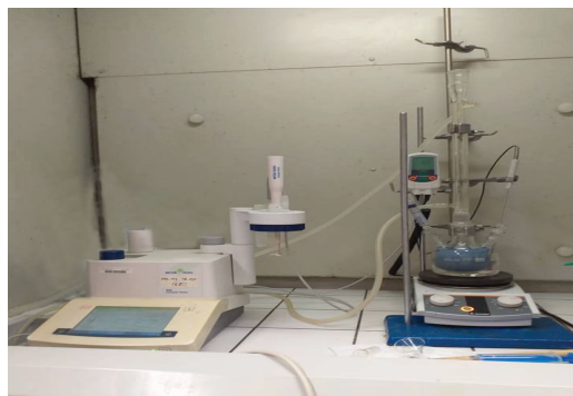
Thủy phân mùn bào da thuộc trong phòng thí nghiệm.
