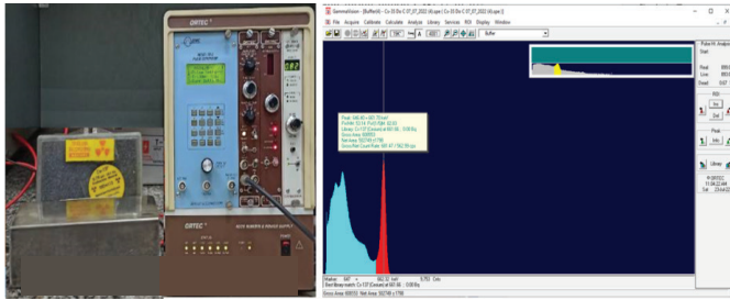
Hình 8. Thực nghiệm đánh giá độ phân giải năng lượng của đầu đo CsI+SiPM.
