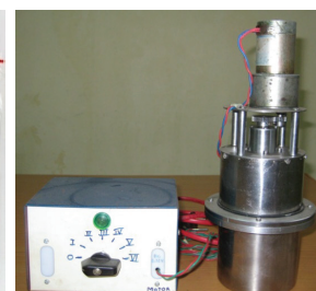
Hình 2. Chuẩn bị mẫu thí nghiệm. (A) Mẫu AP mức siêu mịn để kiểm tra diện tích bề mặt riêng; (B) Thiết bị trộn mẫu chân không mini.
