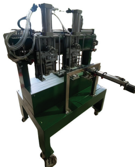
Hình 3. Cụm cơ cấu cắt.
