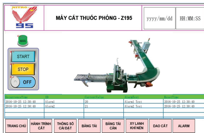
Hình 8. Giao diện điều khiển hệ thống tự động cắt thuốc phóng.
