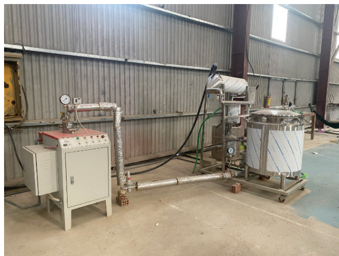
Hình 1. Hệ thống thiết bị chưng cất lôi cuốn hơi nước TBCC-50.
