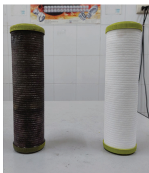
Hình 3. Lõi lọc polypropylene 0,5 μm trước (lõi màu trắng) và sau (lõi màu xám) gắn vật liệu khử khuẩn nano bạc.
