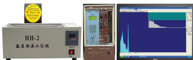
Hình 3. Nguồn phóng xạ, buồng ổn nhiệt và hệ phân tích phổ đa kênh Ortec.
