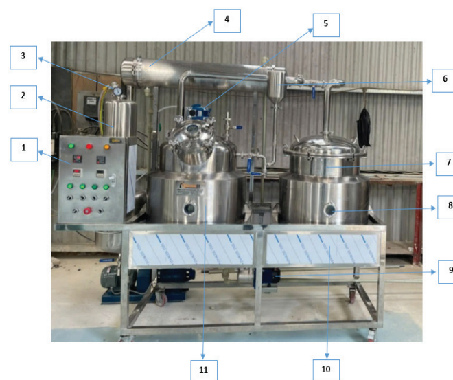
Hình 2. Hệ thống chiết xuất cô đặc chân không CS-ĐCK200. (1) Tủ điều khiển; (2) Bồn chứa; (3) Đồng hồ áp suất âm; (4) Bình ngưng tụ; (5) Cánh khuấy; (6) Hồi lưu; (7) Nồi trích ly; (8) Kính thăm dầu; (9) Bơm chân không; (10) Siêu âm; (11) Nồi cô đặc. Nguồn: Nhóm tác giả.
