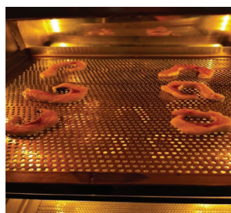
Hình 4. (A) Cá dứa trong thiết bị sấy phối hợp bơm nhiệt và bức xạ hồng ngoại; (B) Cá dứa khô (hình minh họa một khay mẫu cá dứa trong quá trình sấy bằng công nghệ bơm nhiệt kết hợp bức xạ hồng ngoại).
