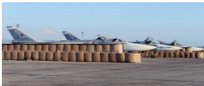
Hình 3. Ụ lắp ghép dã chiến bảo vệ máy bay trên căn cứ không quân của Nga.
