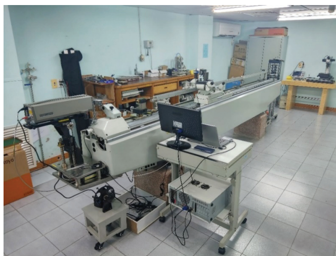
Hình 1. Máy đo độ dài 3 m sử dụng giao thoa kế laser.
