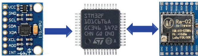
Hình 2. Cấu tạo chính của nút cảm biến.
