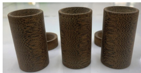
Hình 3. Khối tới hạn của cụm loa phụt làm từ vật liệu composite.
