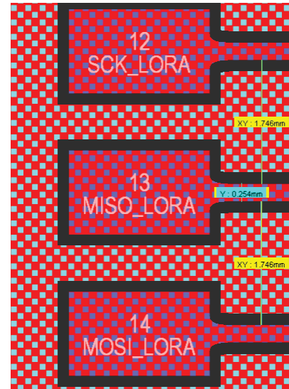
Hình 4. Đi dây dẫn theo nguyên tắc 3W (kích thước đường tín hiệu là 0,254 mm, khoảng cách 2 đường tín hiệu là 1,746 mm).
