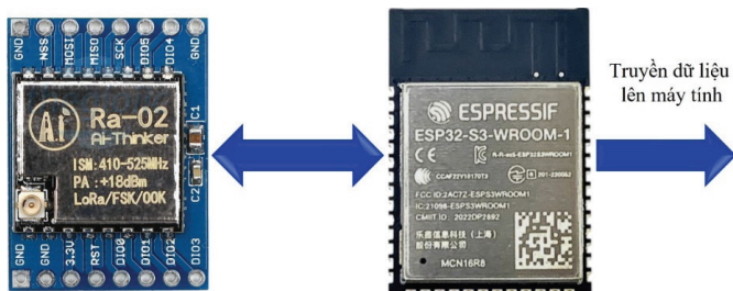
Hình 6. Cấu tạo chính của nút trung tâm.
