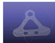
Hình 5. Ảnh đám mây điểm chi tiết phay số 1.
