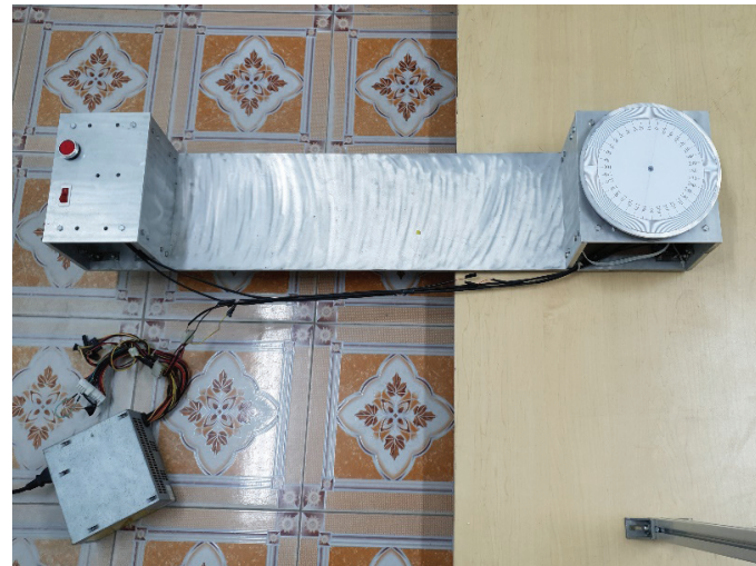
Hình 4. Hệ thống cơ khí hỗ trợ quá trình thu thập dữ liệu theo dịch chuyển quay.
