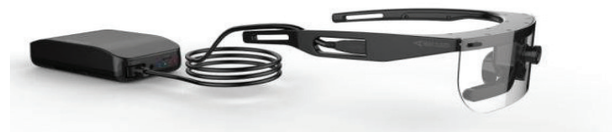
Hình 2. Thiết bị theo dõi chuyển động mắt của người dùng.
