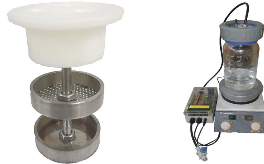
Hình 4. Hình ảnh nắp bình và giá đỡ mẫu trong thiết bị đo compost (A), thiết bị đo compost đã phát triển (B).
