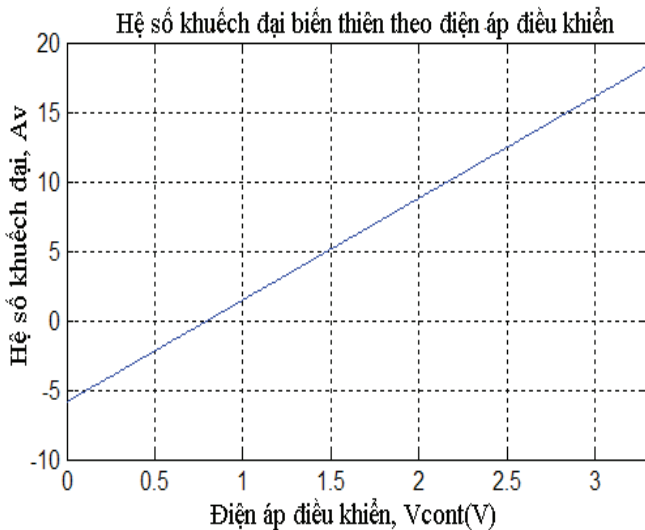
Hình 6: mối quan hệ giữa hệ số khuếch đại và điện áp điều khiển
