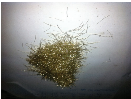
Hình 1: sợi thép thẳng mạ đồng đường kính 0,2 mm, chiều dài 13 mm của Hãng Berker
