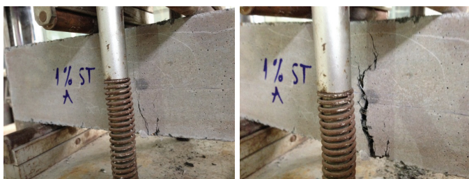
Hình 10: vết nứt bắt đầu hình thành và mở rộng từ từ sang vùng lân cận
