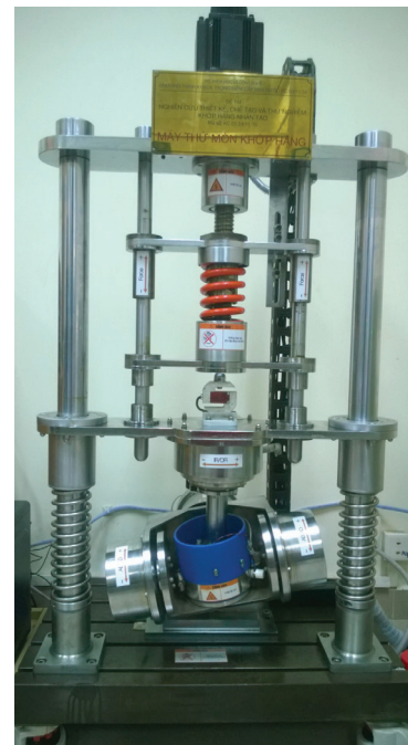
Hình 10: máy thử mòn KHTP
