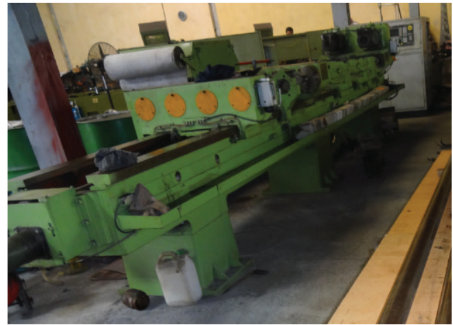
Hình 3: máy khoan lỗ sâu gundrill 4 trục
