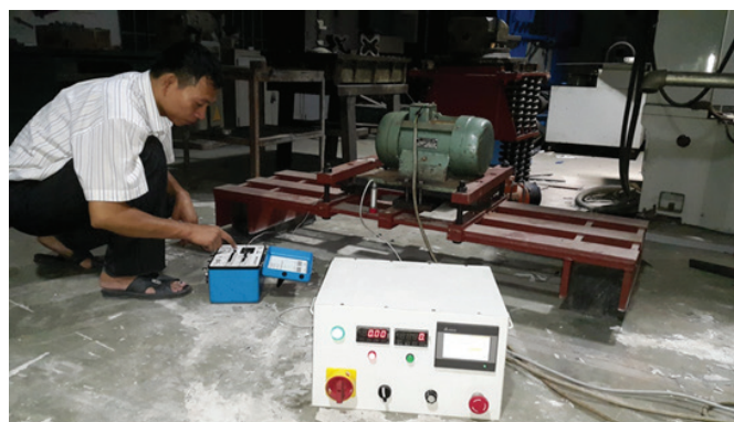
Hình 3: kết cấu có gắn đầu rung khử ứng suất
