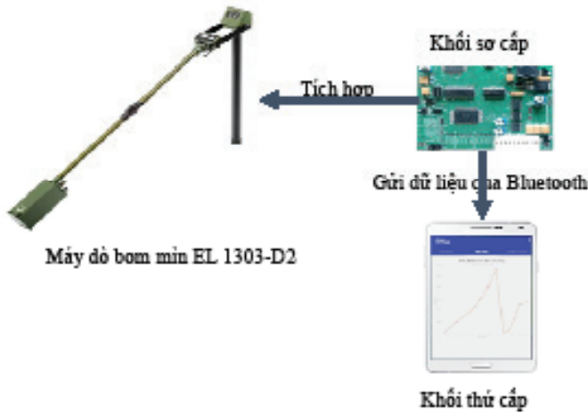
Hình 5. Mô hình thiết kế bộ thiết bị nhúng tích hợp máy dò bom Vallon EL 1303-D2.
