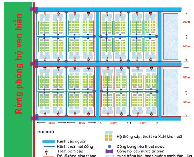
Hình 1. Sơ đồ mặt bằng bố trí HTTL từ nguồn đến nội đồng áp dụng cho khu nuôi cấp nước bằng cống tự chảy (có hỗ trợ bơm cấp) trực tiếp từ kênh cấp nguồn.
