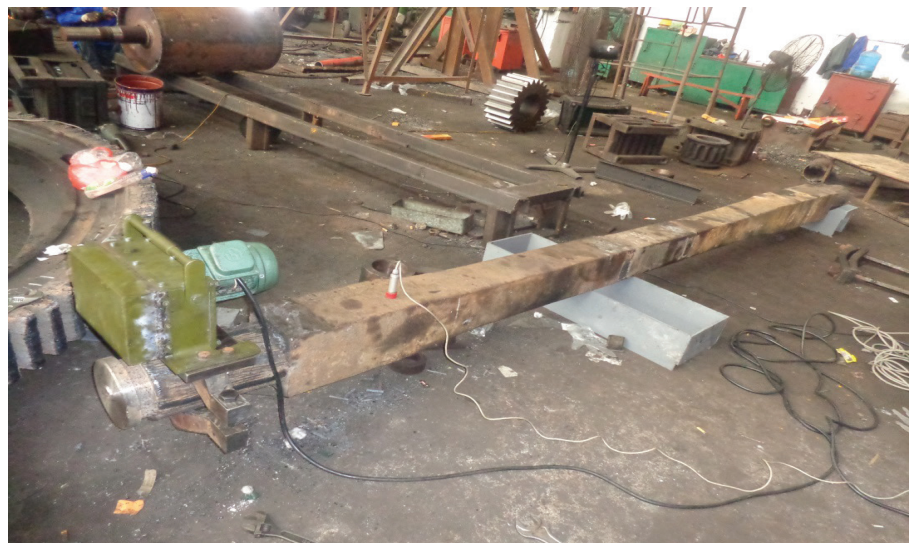
Hình 4. Rung khử ứng suất dư cho chi tiết trục căng xích.
