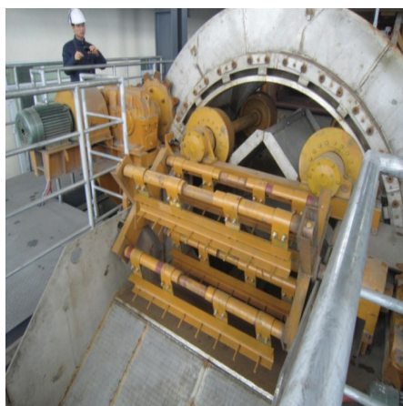
Hình 3. Máy MTHP-20 do IEMM-TKV thiết kế, chế tạo được lắp đặt tại Nhà máy sàng tuyển than Vàng Danh 2.
