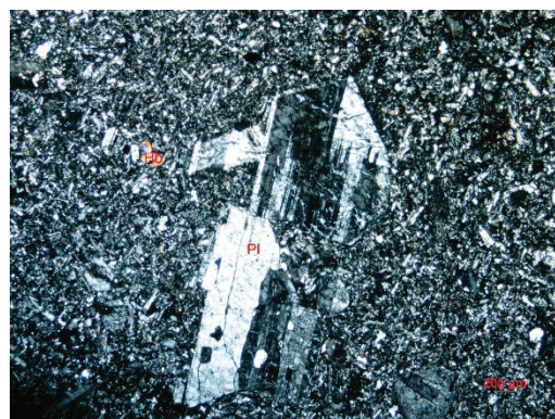
Hình 2. Ban tinh plagioclase trong andesit, lát mỏng PY13/2, (+), X10.
