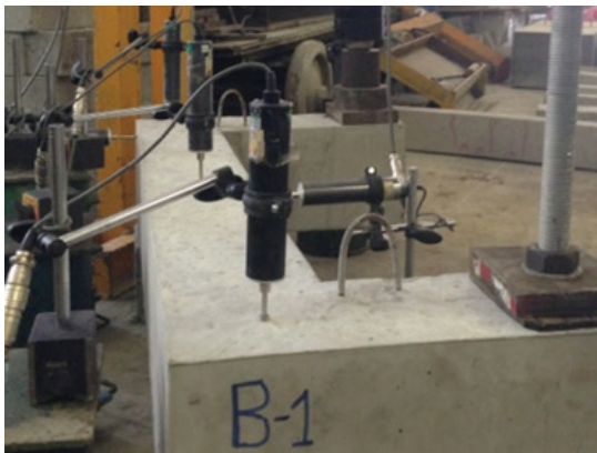
Hình 11. Hình ảnh bố trí các dụng cụ đo chuyển vị LVDT.
