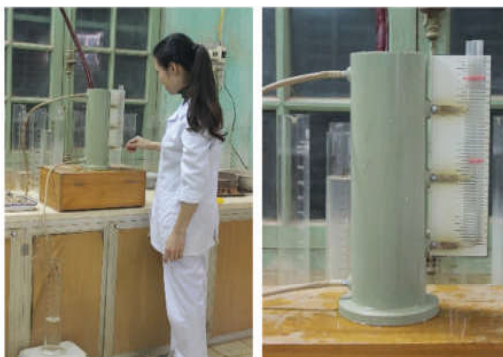
Hình 6. Thí nghiệm trong phòng xác định hệ số thấm của cát sỏi.
