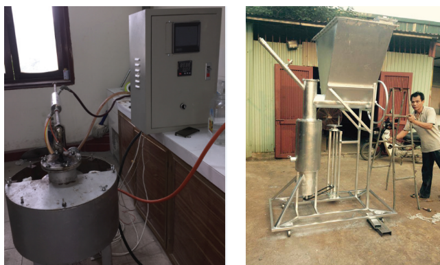
A) Thiết bị khí hóa thí nghiệm. B) Mô hình thiết bị khí hóa liên tục.
