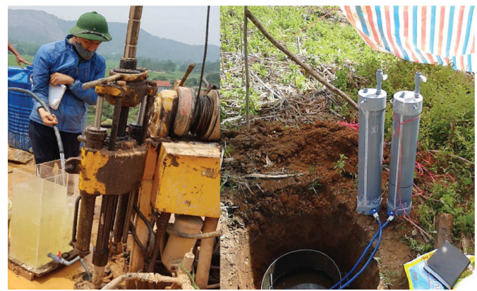
Hình 7. Thí nghiệm đổ nước hố khoan, hố đào xác định hệ số thấm của các lớp đất.
