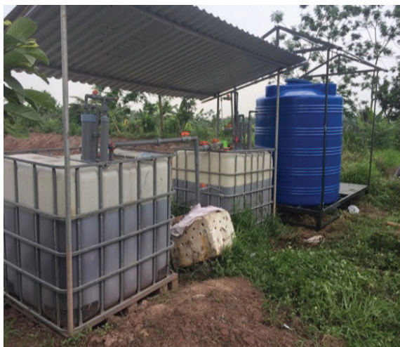
Hình 2. Hệ nghiên cứu đồng phân huỷ kỵ khí.
