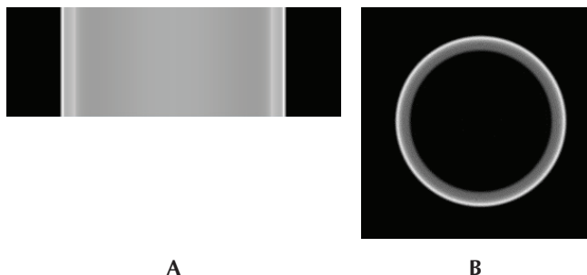
Hình 5. Bộ số liệu hình chiếu (Sinogram) từ kết quả mô phỏng MCNP (A) và hình ảnh tái dựng bằng thuật toán FBP và hình học dựng ảnh thể hệ thứ tư (B).
