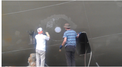
Hình 10. Lắp đặt điện cực anốt trên thân tàu Minh Phú 99.
