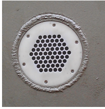
Hình 10. Lắp đặt điện cực anốt trên thân tàu Minh Phú 99.
