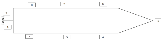
Hình 12. Sơ đồ các vị trí đo kiểm tra điện thế của vỏ tàu.
