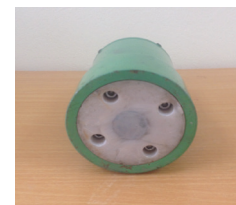
Hình 8. Hình ảnh điện cực so sánh Zn chế tạo cho hệ thống ICCP.
