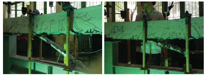
Hình 7. Hình ảnh phá hủy mẫu đầm được gia cường bằng tấm CFRP.
