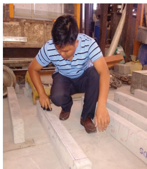
A- Vệ sinh, làm phẳng bề mặt mẫu trước khi dán gia cường.
