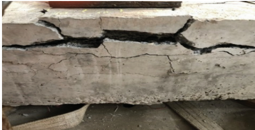
Hình 18. Phá hủy mẫu thử liên kết bulong.
