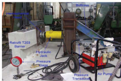
Hình 4. Mô hình thử nghiệm tĩnh trong phòng thí nghiệm.
