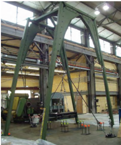
Hình 3. Mô hình và chạm bằng con lắc.
