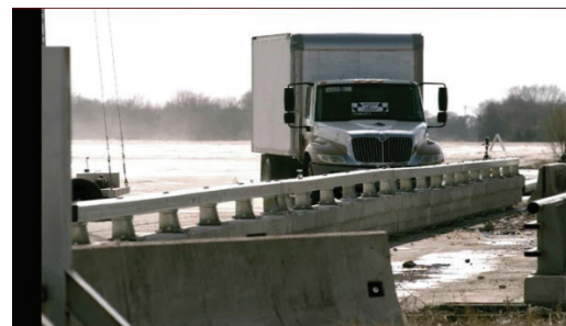
Hình 2. Mô hình xe đâm vào lan can.
