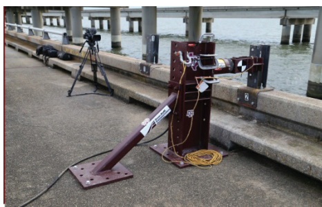
Hình 5. Mô hình thử nghiệm tĩnh ngoài hiện trường.
