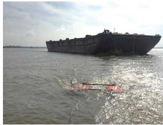
Hình 6. Đầu phát xung âm học và máy thu tín hiệu kéo theo tàu khảo sát.
