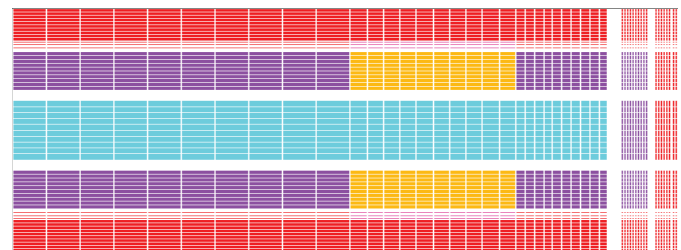
Hình 3. Mô hình phần tử hữu hạn dùng phân tích mạch từ của ly hợp.
