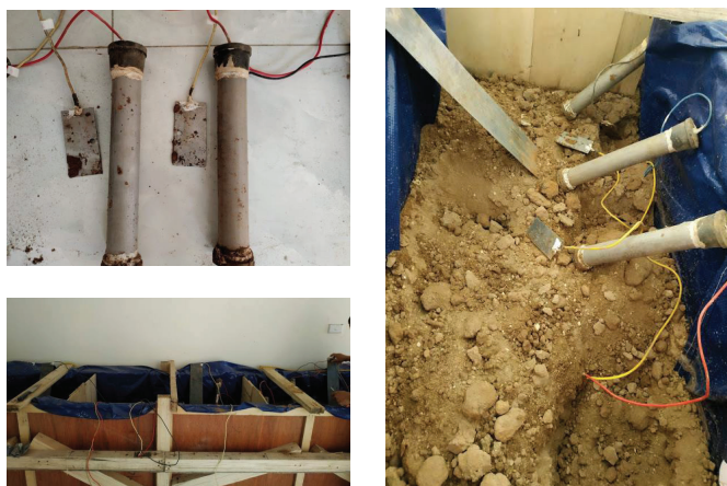
Hình 2. Hình ảnh chuẩn bị thí nghiệm bảo vệ catot cho các mẫu thép trong môi trường đất.
