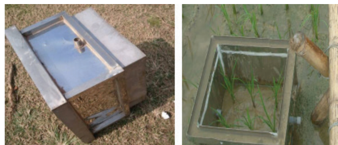
Hình 3. Cấu tạo và cách đặt chân đế của chamber [18].
